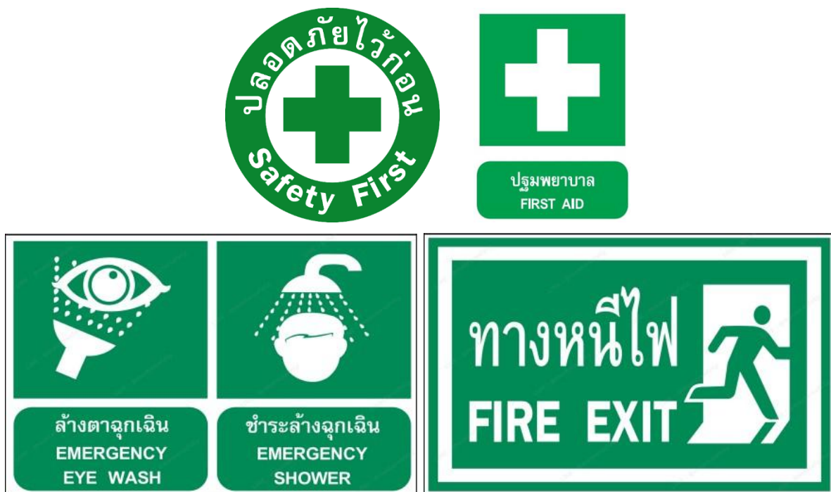
รูปที่ 4.14 ตัวอย่างป้ายเครื่องหมายสภาวะปลอดภัยและจุดตอบสนองฉุกเฉิน
