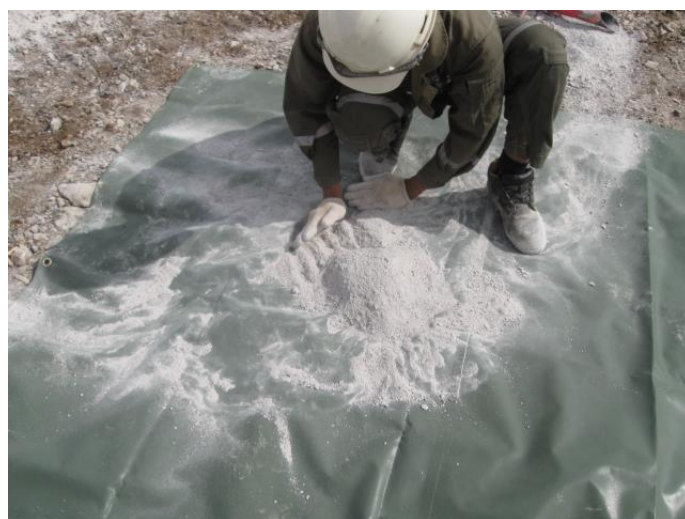
รูปที่ 3.9 แสดงวิธีการเก็บตัวอย่างผงฝุ่นไผ้ไควเคราะห์
